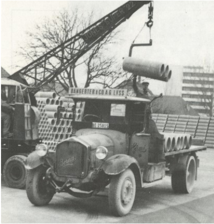
Der erste Lastwagen «Sämi» der Marke Berna: Er wurde 1924 angeschafft und verfügte über Vollgummireifen, Handhufe, Motorpeife, Karbidscheinwerfer und Laternen.
