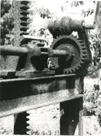
Zahnräder der Pritschen bei der ehemaligen Armaturenfabrik (am Ende der heutigen Fabrikstrasse), deren Vorgängerbetrieb von Mühlenbauer Bangerter erbaut wurde, der gleichzeitig Gründer der Firma Bangerter Zementwaren 187 war (Foto: Max Gribi)
