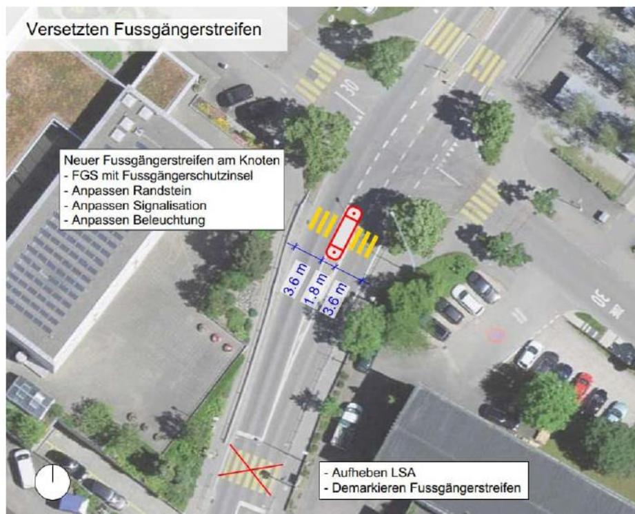
Abb. 1: Planskizze: Versetzen Fussgängerstreifen
