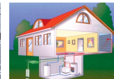
Das Erdreich hat im Mittelland ab einer Tiefe von rund 15 Metern das ganze Jahr eine konstante Temperatur von rund 10 Grad und eignet sich deshalb gut als Wärmequelle für Wärmepumpen.
