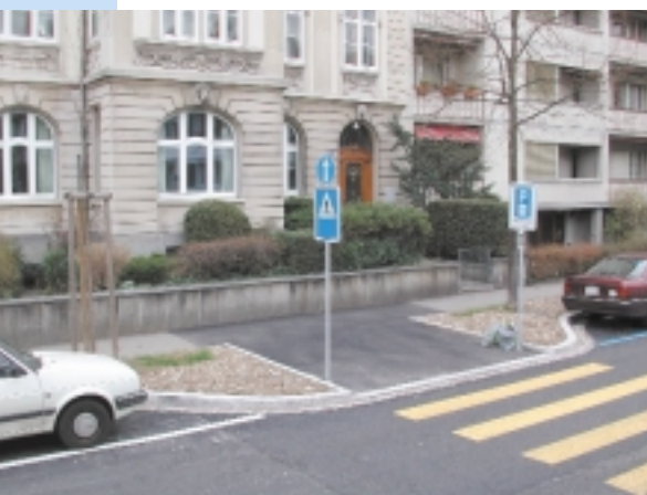
Der mit einer Trottoirnase verkürzte und damit gesicherte Fussgängerstreifen ist ein probates Mittel der Schulwegsicherung.
