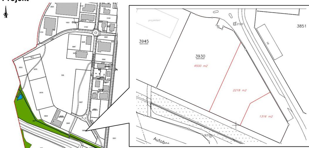
Die Roder Transporte beabsichtigt eine Stahlhalle mit einer Fläche von rund 25 x 60 Meter zu realisieren. Sie soll als Werkhalle und Abstellfläche für LKW's und Auflieger dienen.
